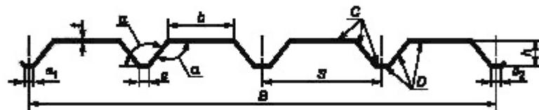
*B* — монтажная ширина профиля; *h* — высота профиля; *l* — толщина профиля; *S* — шаг гофров; *a* и *b* — ширина полок профиля (может быть *a* = *b*); *a*<sub>1</sub> и *a*<sub>2</sub> — ширина крайних полок гофров профиля (разность между ними должна быть не менее 2 мм)
