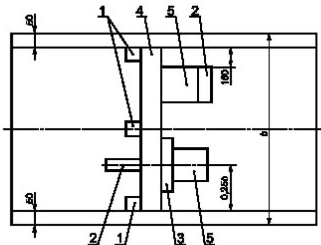
б — ширина проката, мм; 1, 2, 4, 5 — образцы; 3 — заготовка
