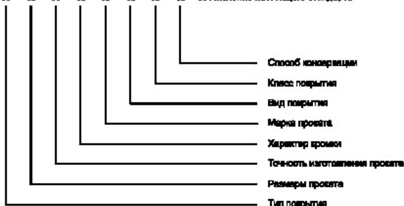
Прокат с цинковым покрытием ГЦ в листах толщиной 1,0 мм, шириной 1000 мм, длиной 2000 мм, категории точности изготовления Б, с необрзной кромкой НО, марки 01, с покрытием с нормальным узором кристаллизации цинка Н, класса 275, промасленный ПР:
